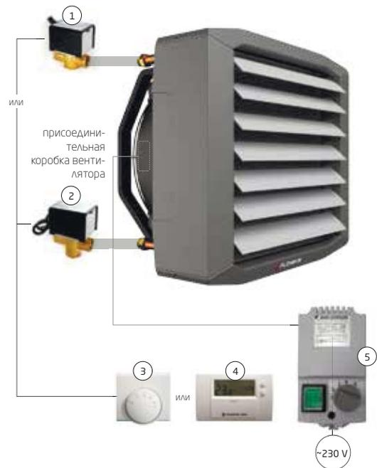
1. SRQ2d – двухходовой клапан с сервоприводом
